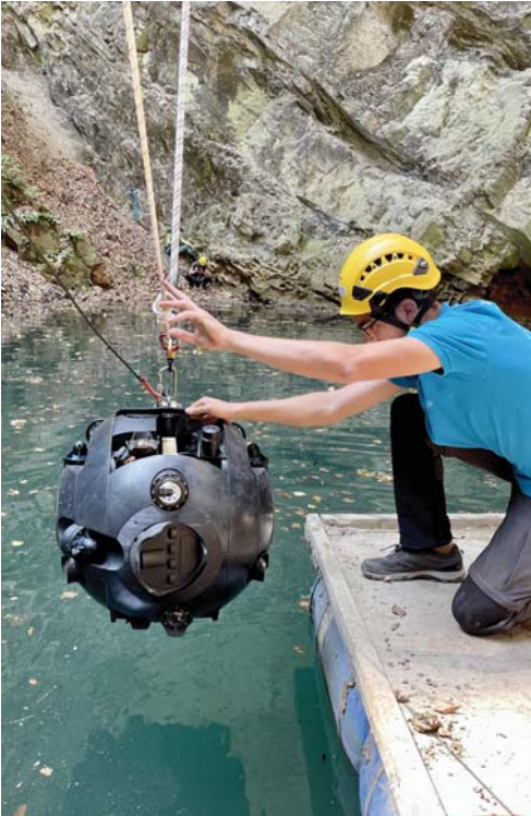
Spouštění robota ROV Unexmin GeoRobotics z plovoucího pontonu na hladině Jezírka. Foto Pavel Fryšák
