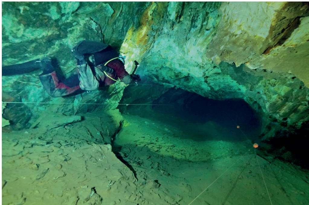
Severní koridor Hlavní chodby. V pravé části snímku šňůry kontrolního polygonu se signalizačními znaky. Foto Miloslav Dvořáček
