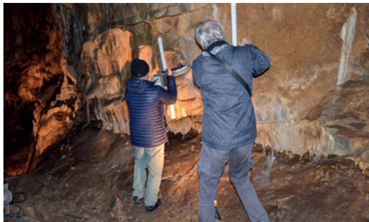
Netypické použití georadaru pro měření na vertikální stěně jeskyně. Foto Jiří Hebelka
