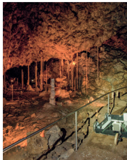
Georadarový profil měřený po turistické trase Kateřinské jeskyně za účelem zjištění mocnosti jeskynních sedimentů. Foto Petr Zajíček
