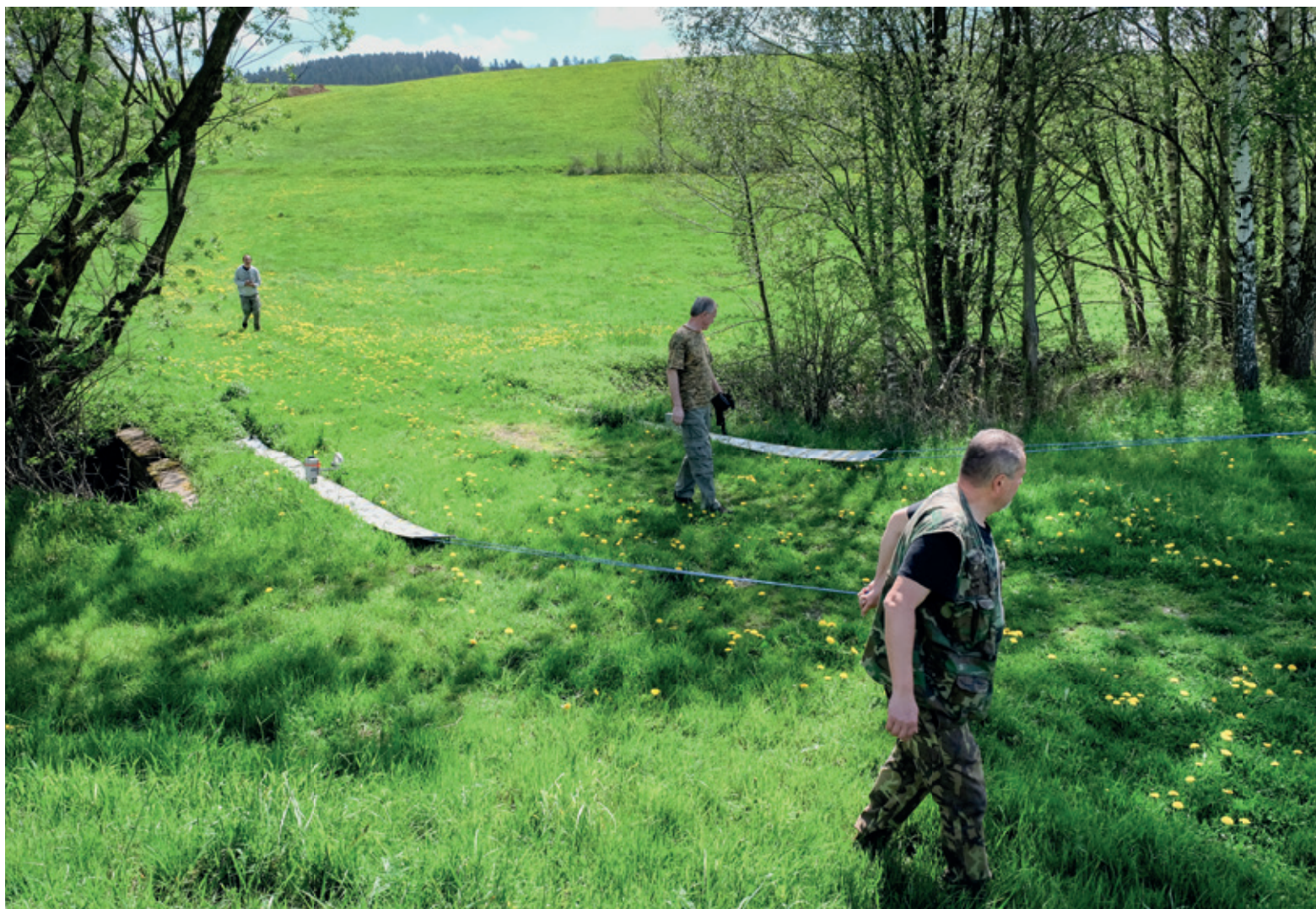
Georadarový průzkum na povrchu krasového tělesa v okolí jeskyně Ponikelské propadání s použitím dlouhých antén tažených lidskou silou. Foto Vratislav Ouhrabka
