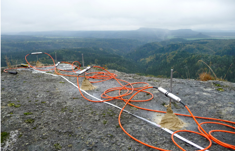
Obr. 7 Elektro rezistivní tomografie, měření odporů pomocí jílových hromádek. Foto Jakub Šafránek
