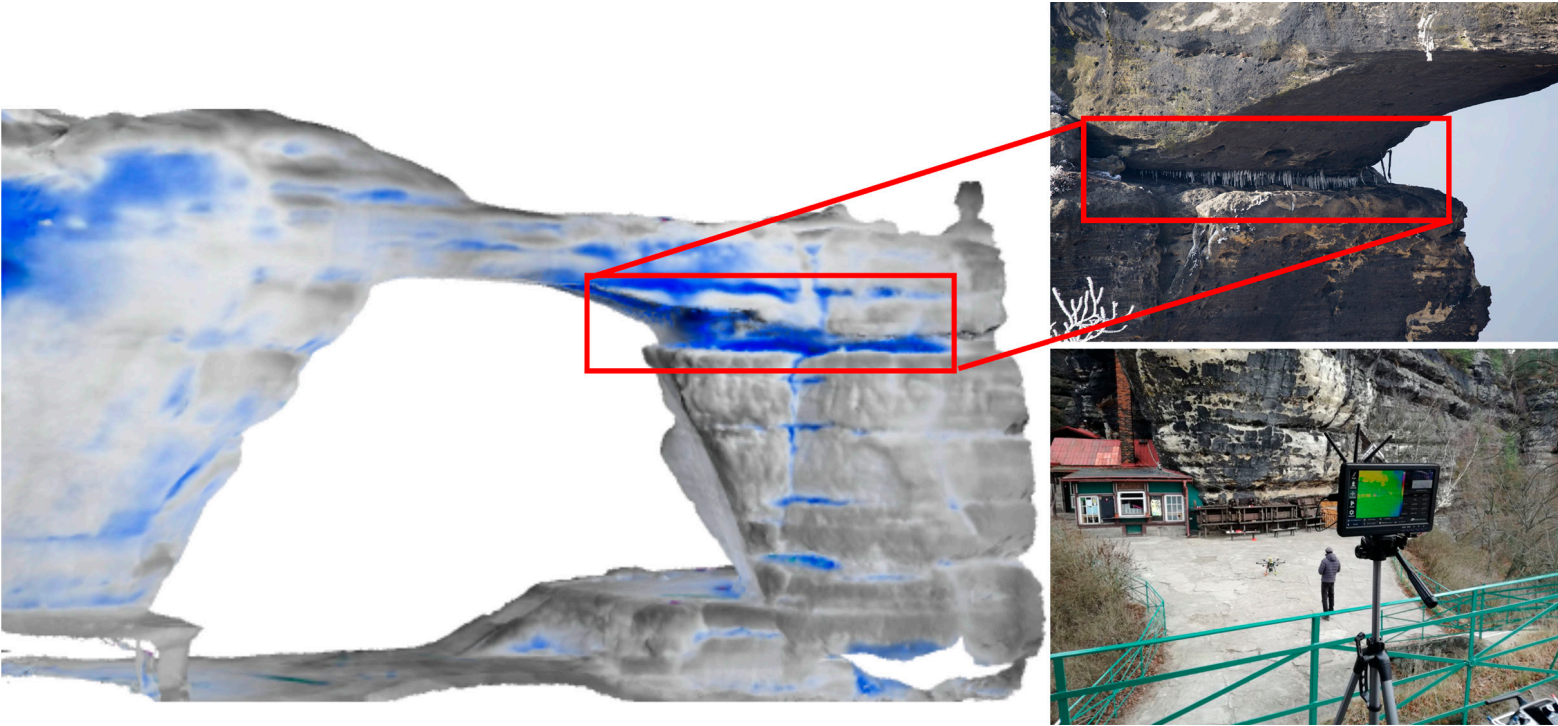
Obr. 6 Termometrie Pravčické brány pomocí dronu. Archiv Správy NP České Švýcarsko
