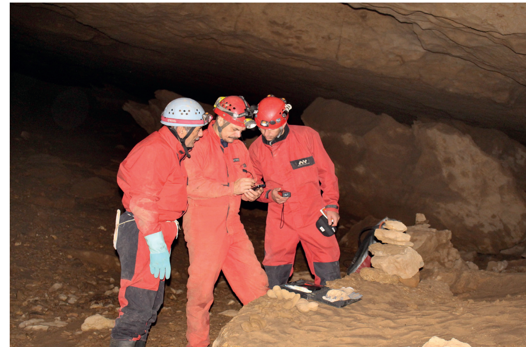
Mapování jeskyně pomocí speciálně upraveného dálkoměru Disto X. Foto Valerii Barbagadze
