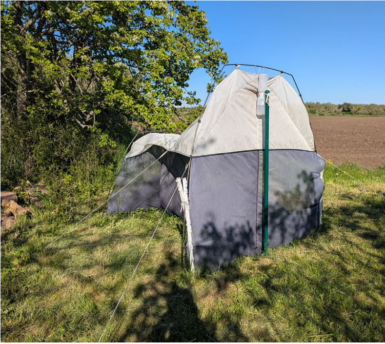
Obr. 4: Malaiseho past je pasivní stanový lapač sloužící k efektivnímu odchytu létajícího hmyzu (především dvoukřídlých a blanokřídlých). Hmyz naráží do středové přepážky, letí vzhůru a padá do sběrné lahve s konzervačním médiem. Foto Jonáš Gaigr
