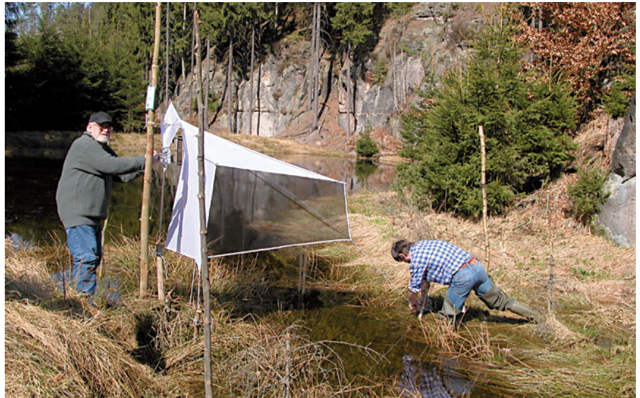
Pro účely monitoringu ohrožených druhů hmyzu se používají samočinná odchyťová zařízení, tzv. Malaiseho pasti.
