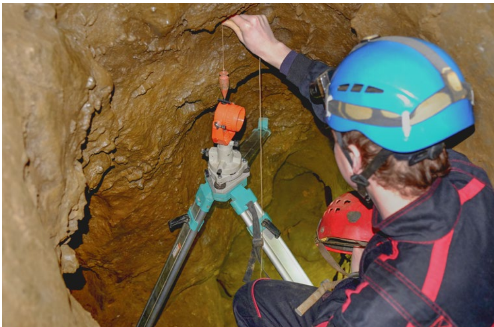
Pro potřeby nového mapování některých jeskyní bylo nutné zřídit přesné bodové pole, což se často neobešlo bez krkolomného umístění stativu. Foto Vratislav Ouhrabka
