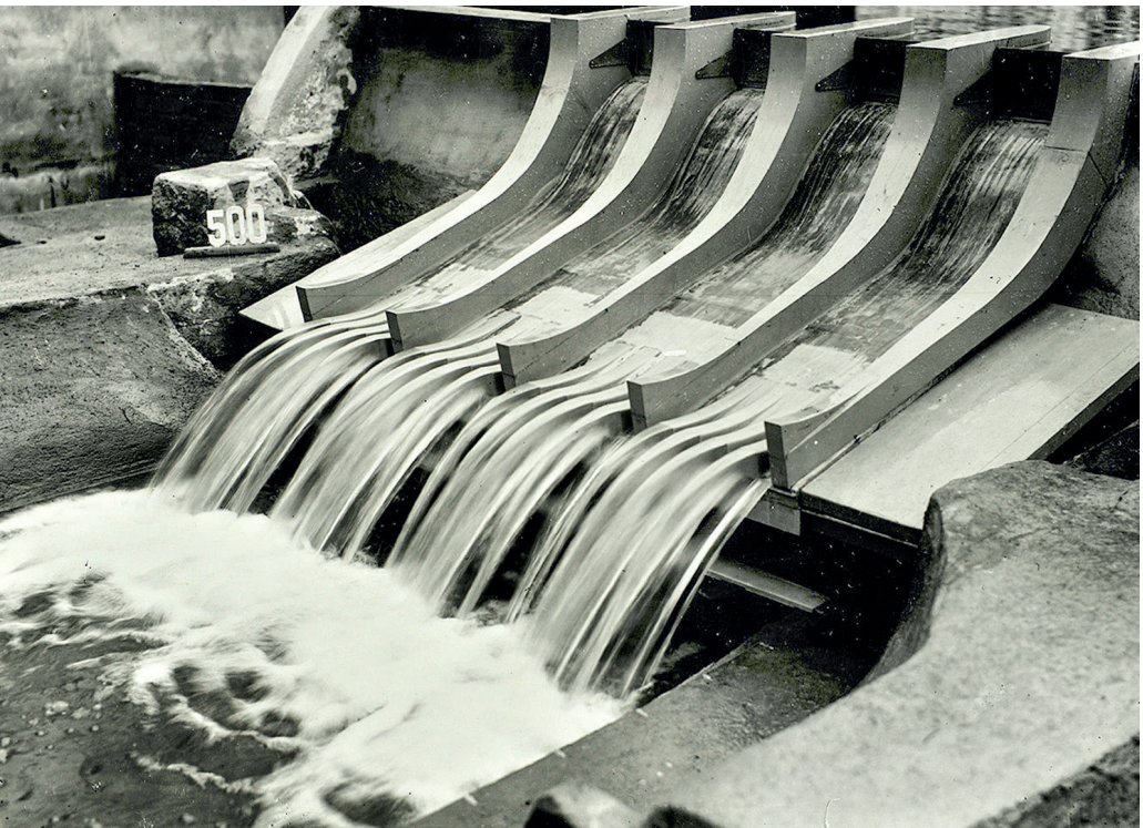
Obr. 1 Fyzikální model VD Slapy, detail přelivu a vývaru při převádění průtoku 500 m³/s, počátek 50. let 20. století. Foto archiv VÚV TGM
