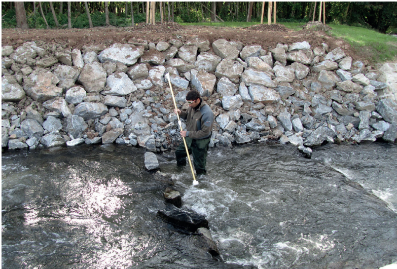
Monitoring hydrometrováním proudných rychlostí. Foto archiv AOPK ČR
