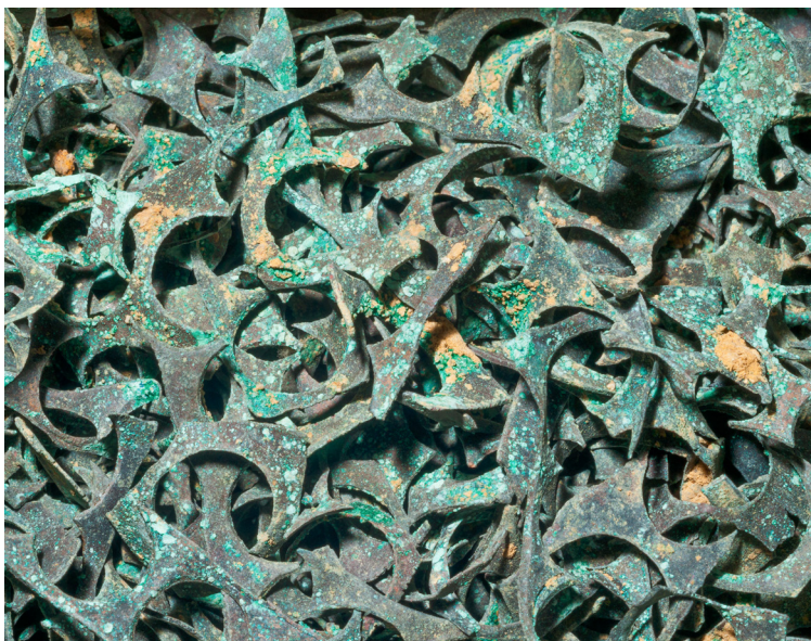
Odstřížky měděného plechu z Mincovny na Zlatém koni, zbytky po výrobě falešných mincí. Foto Alexandr Komaško
