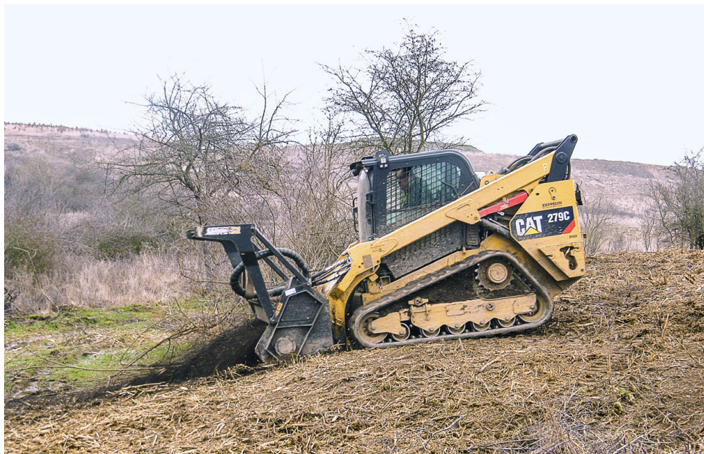
Obr. 3 Ukázka frézování pomocí mulčovací hlavy ( mulching ) na smykovém pásovém nakladači. Výsledkem je totální destrukce s následným ponecháním veškeré biomasy na ploše. Foto Ondřej Peksa
