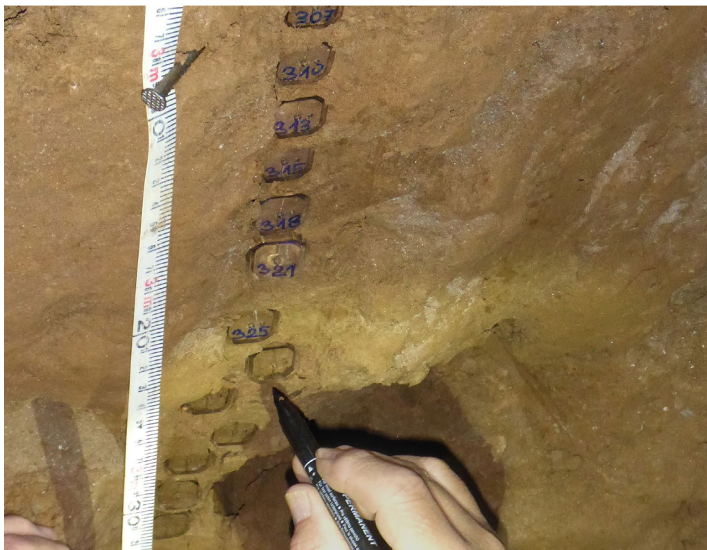
Odběr orientovaných vzorků sedimentů pro paleomagnetické datování se provádí do malých plastových krabiček zatlačovaných do jílu. Foto Radko Tásler
