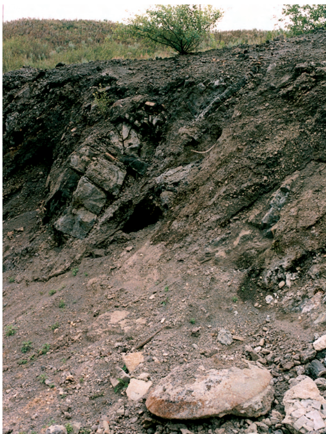
Materiál haldy poněkud připomíná neovulkanické horniny blízké Vínarické hory. Je pro něj charakteristické střídání struskových a popelovitých partií. Struska byla v mnoha případech vylévána ve žhavém stavu. V popředí vidíte „lupu“ surového železa o váze přes 50 kg
