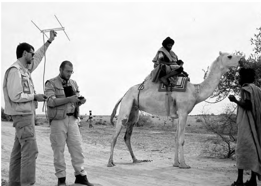
Zaměřování pozemního vysílače samičky čápa černého, Dominiky, na jihu Mauritánie v prosinci 1999. Pozemní vysílač, který má dosah několik kilometrů, umožňuje sledovaného jedince dohledat přímo v terénu a buď ho sledovat vizuálně, nebo podle měnících se signálů vysílače usuzovat na jeho chování
