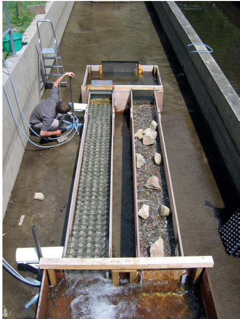
Pohled na dřevěné žlaby s protékající vodou používané ke zkoušení různých typů zdrsňení dna pro usnadnění protiproudových migrací mihule potoční. Foto Sylvain Besson
