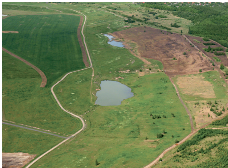
Obr. 3 (vlevo): Při technických rekultivacích je terén zarovnan, odvodněn a případně zúrodněn navezením ornice. V horní části obrázku z Radovesické výsypky je vidět prostředí vzniklé spontánní sukcesí, ve spodní části výsledek technické rekultivace.
