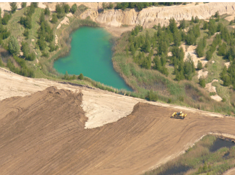
Obr. 3 (vlevo): Při technických rekultivacích je terén zarovnan, odvodněn a případně zúrodněn navezením ornice. V horní části obrázku z Radovesické výsypky je vidět prostředí vzniklé spontánní sukcesí, ve spodní části výsledek technické rekultivace.
