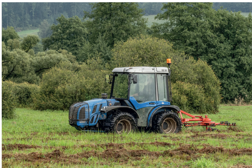
Obr. 4: Příklad speciálního malotraktoru s nízkotlakými pneumatikami. Foto Václav Bystřický
