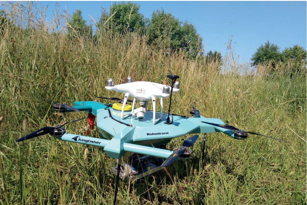
Obrázek 2 Bezpilotní systémy v terénu (vzletová hmotnost 9 a 1,5 kg). Foto Jan Komárek
