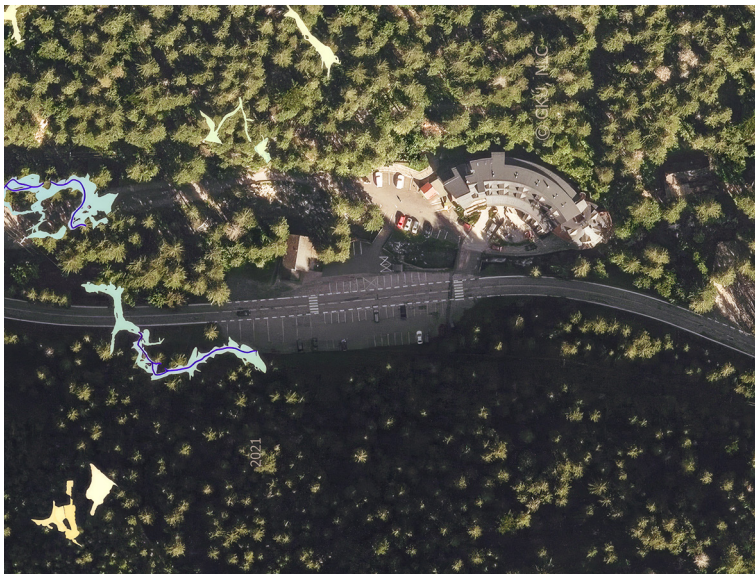
Obr. 5: Fragmenty známých častí jaskýň, vedúcich popod frekventovanú cestu 2. triedy do Jasnej, sa nachádzajú len 2 až 5 m pod vozovkou. Cez tieto jaskyne preteká vodný tok, ktorý je súčasťou najdôležitejšieho vodného zdroja na Liptove. Autor: Pavel Herich z podkladov vlastných a GKÚ, NLC.
