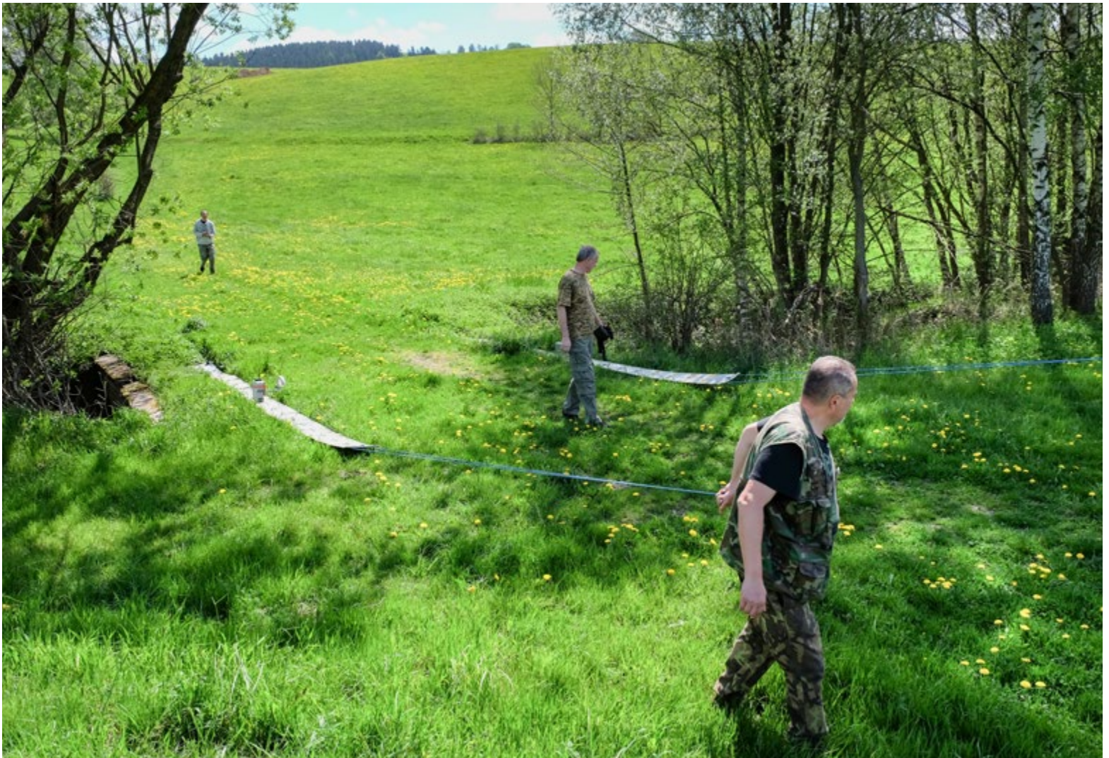
Georadarový průzkum na povrchu krasového tělesa v okolí jeskyně Ponikelské propadání s použitím dlouhých antén tažených lidskou silou. Foto Vratislav Ouhrabka
