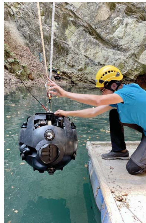
Spouštění robota ROV Unexmin GeoRobotics z plovoucího pontonu na hladině Jezírka. Foto Pavel Fryšák
